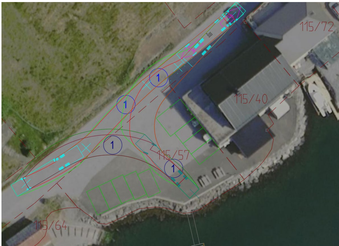
Figur 9: Sporingskurve for boggibuss (B), 15 m lang, 3-aksla. Viser snumoglegheit på området vest for butikken.
