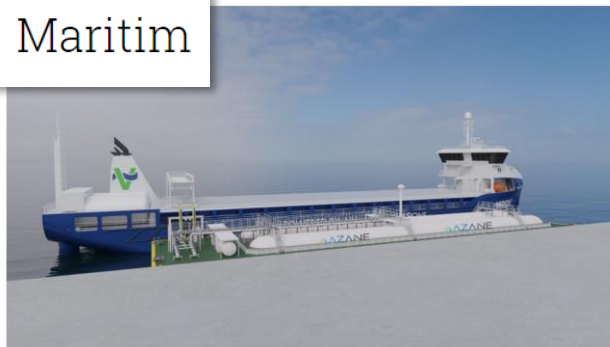
Bunkeringsanlegg tilpasset ammoniakk er viktig når skip skal fylle drivstoff. Leker med ammoniakktanker ligger mellom kaia og et av de planlagte bulkskipene til Viridis. (Bildegrip: Azane Fuel Solutions)
