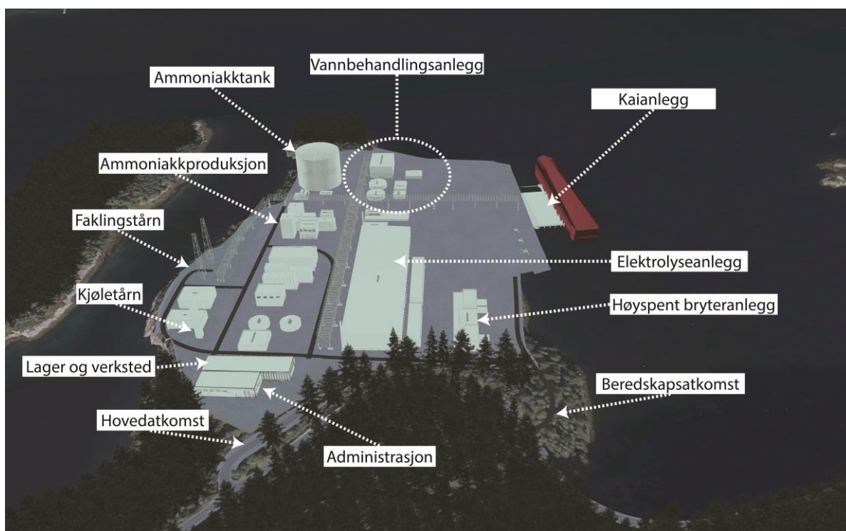
Figur 28: Illustrasjon av foreløpig teknisk plan for anlegget i planalternativ 2b.
