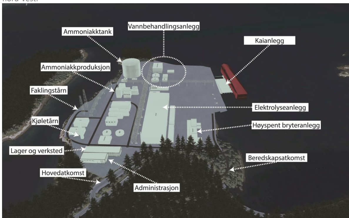
Figur 25: 3D illustrasjon av planalternativ 2b, med forklaring på de ulike delene av produksjonsanleggene. Her kan det sees at det ikke fylles ut i Djupevika, at hovedatkomsten legges lenger vest og at det etableres en beredskapsatkomst like vest for Djupevika.
