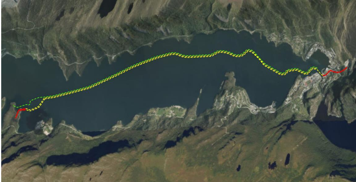
Figur 54: Trasé for sjøkabel for strøm- og vanntilførsel fra Svelgen.
