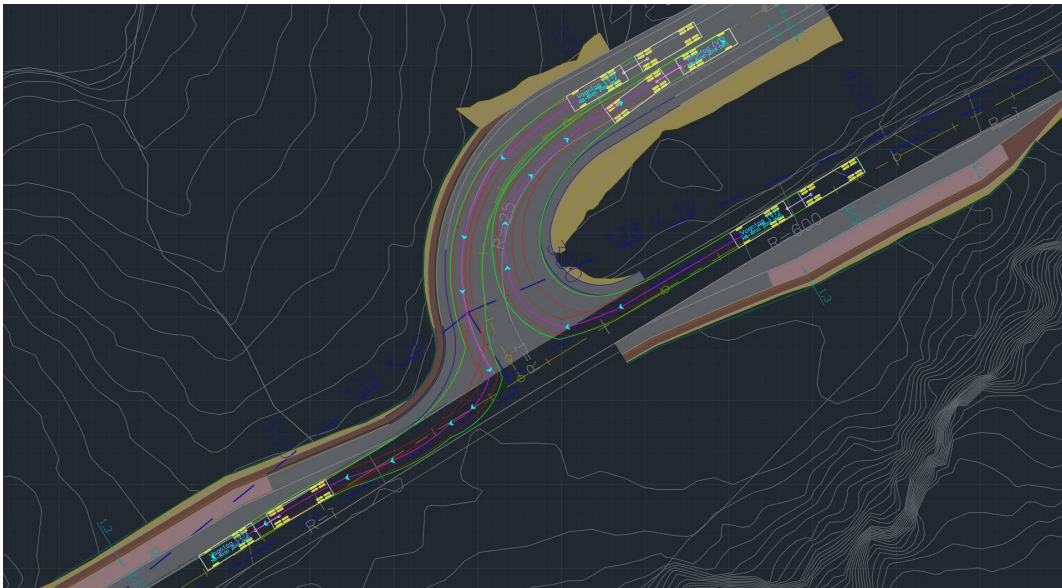
Figur 22 – Adkomstveg planalternativ 2b med sporing av innkjørende og utkjørende vogntog
