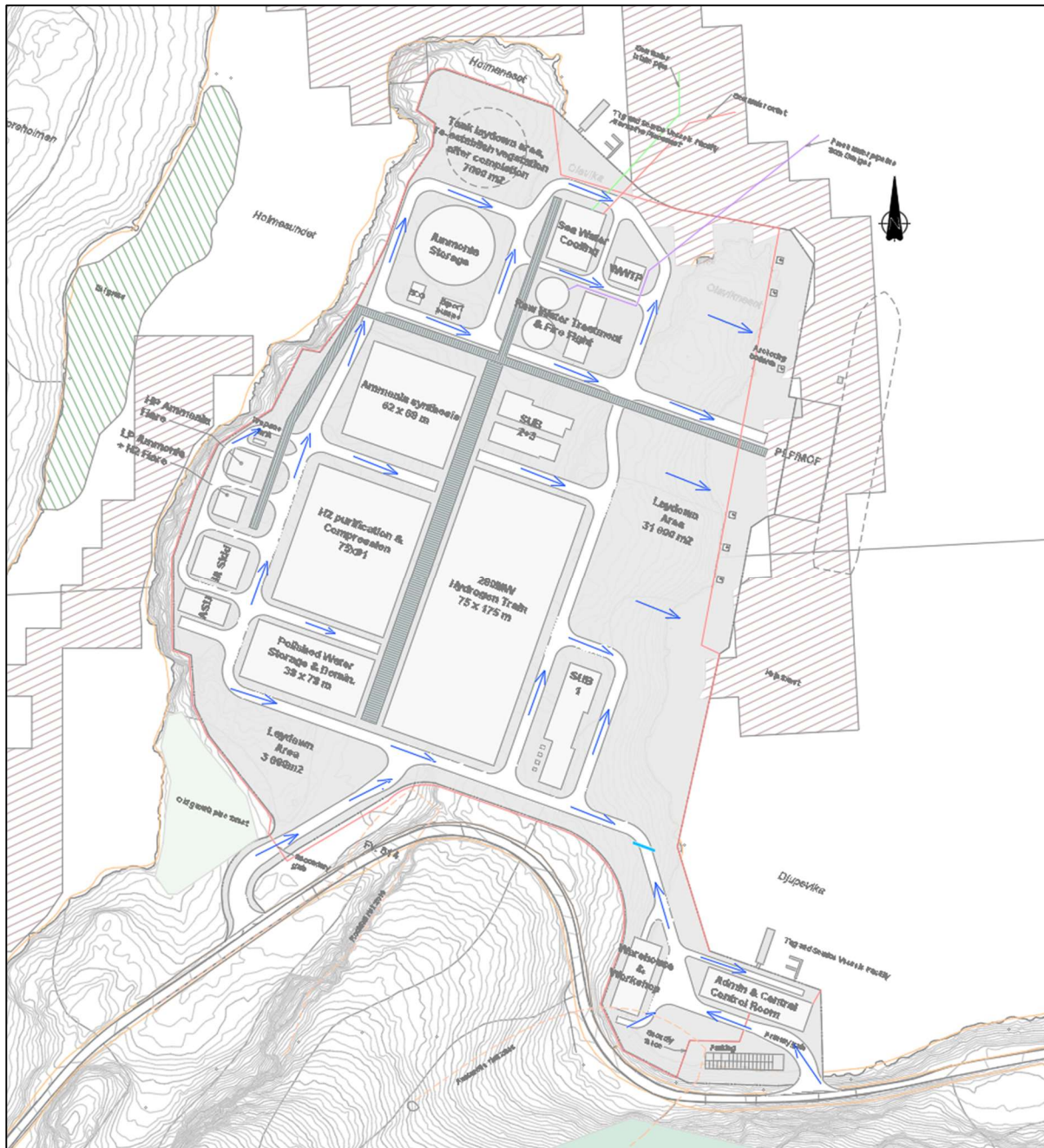
Figur 7: Oversikt over avrenningsplan for prosjektert situasjon.
