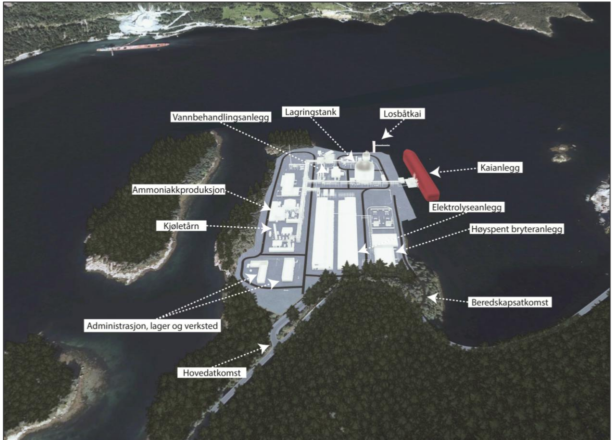
Figur 24: 3D illustrasjon av planforslaget, med forklaring på de ulike delene av produksjonsanlegget.
