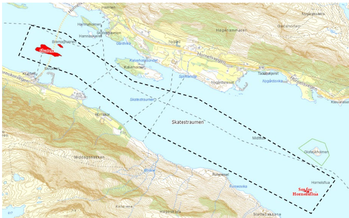
Figur 4-11 Skaten og Hornelsflua. Stipla line viser kabel. Stipla gul line er undersjøisk tunell. Raude felt er utdypingsområde.
