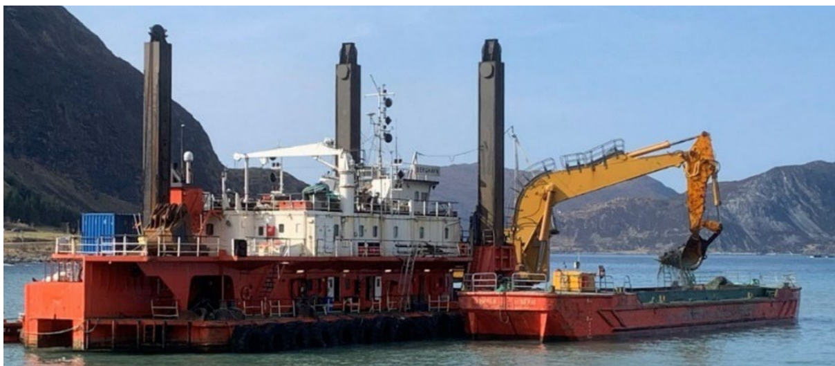
Figur 2-6 Utdjuping vil bli utført frå eit mudringsfartøy. Steinmassane som blir sprengt ut blir teke opp og mellomagra på lekter før dei blir frakta til eit regulert deponi på sjøbotn eller til eit område på land.
